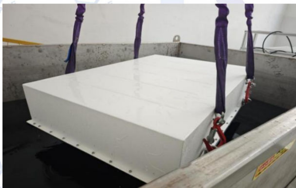
IPX7 架设照片 installation photo
